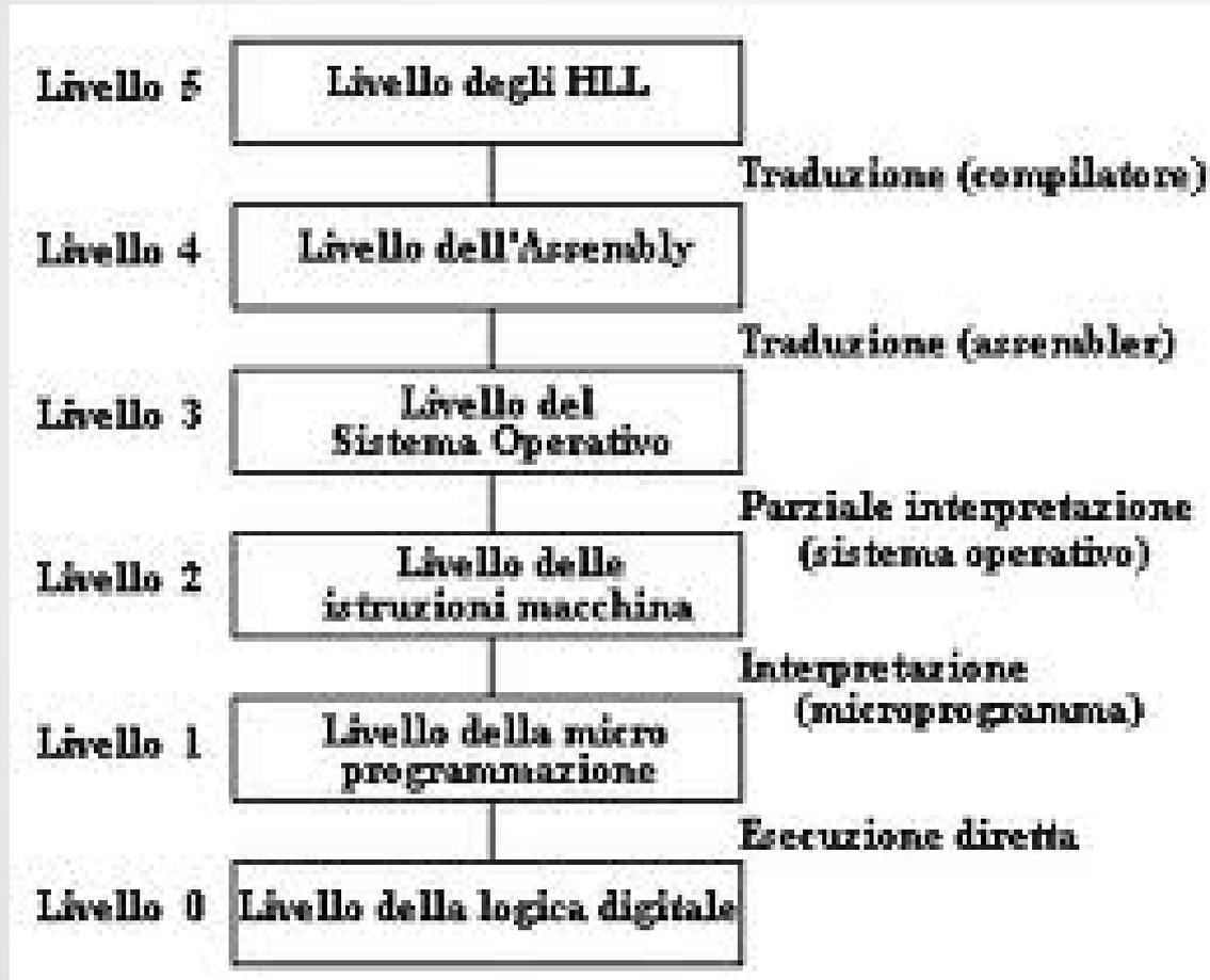
Il livello L0 rappresenta il computer reale ed il linguaggio macchina che esso è in grado di eseguire direttamente. Ogni livello superiore rappresenta una macchina astratta. I programmi (istruzioni) di ogni livello superiore devono essere o tradotti in termini di istruzioni di uno dei livelli inferiori, o interpretati da un programma che gira su di una macchina astratta di livello strettamente inferiore.
