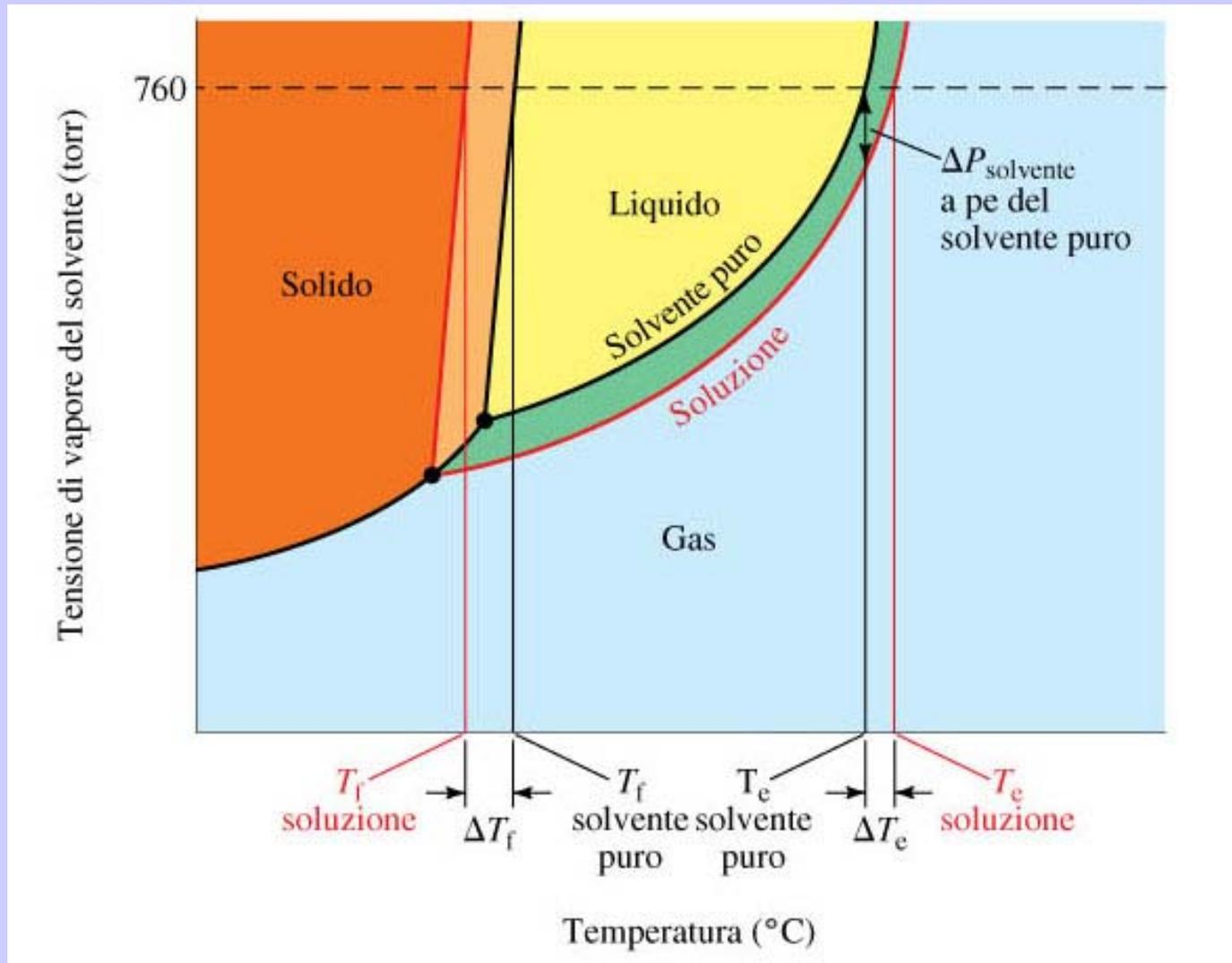
Un diagramma di fase completo mostra che per una soluzione si ha un innalzamento del punto di ebollizione e un abbassamento del punto di fusione rispetto al solvente
